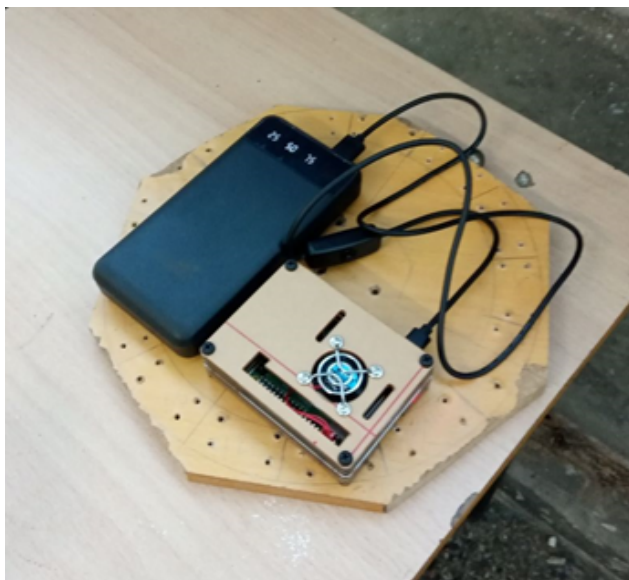
Figura 2. Plataforma Moodlebox instalada en una Raspberry Pi 4B junto con su banco de baterías, durante una clase presencial. (Fuente: elaboración propia).
