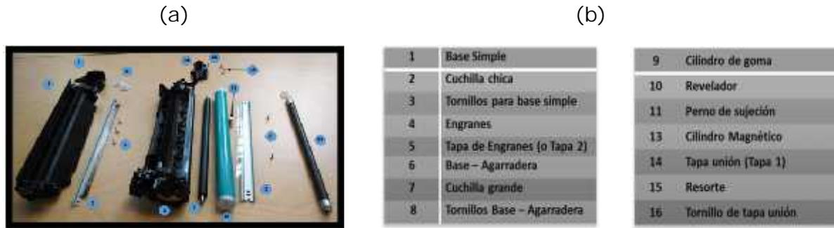
Figura 2. (a) Cartucho de impresora láser y (b) componentes utilizados en su proceso de ensamble. Fuente: Elaboración propia
