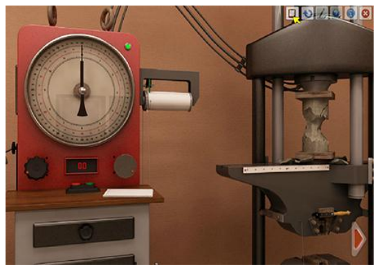
8. Vista rotura de la probeta
